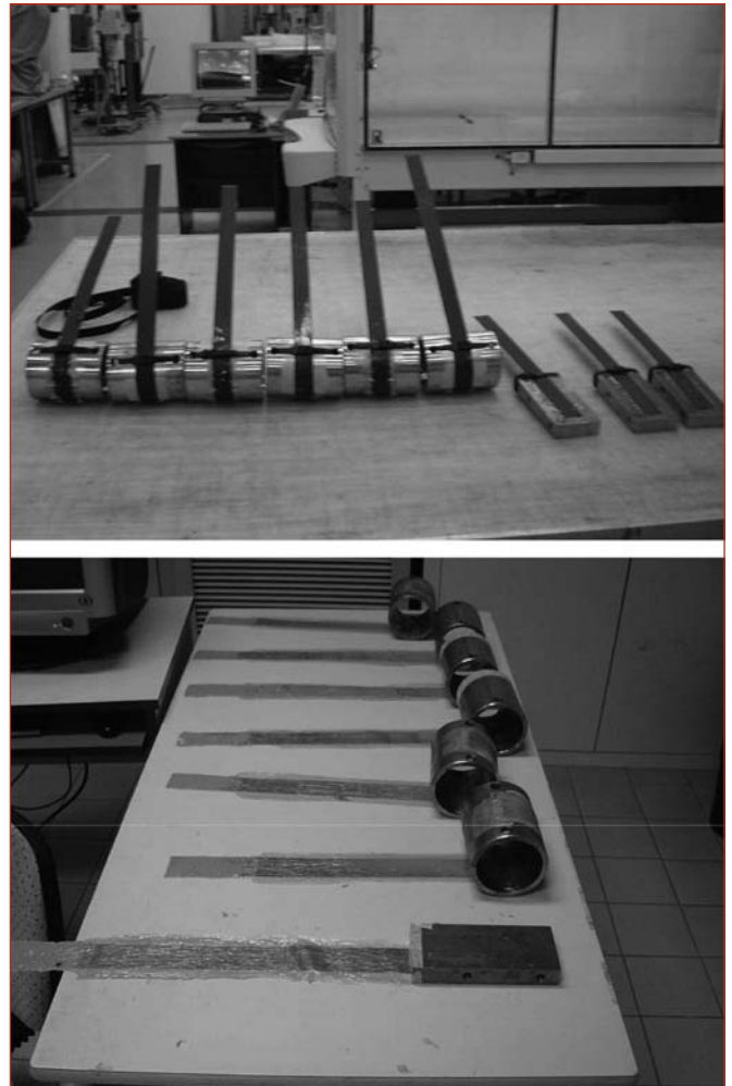
Figure 12 : Photo des joints collés réalisés avec empilements d'UD pré-imprégné avec une résine polymérisant à chaud à gauche, et tissu imprégné de résine polymérisant à froid à droite.
